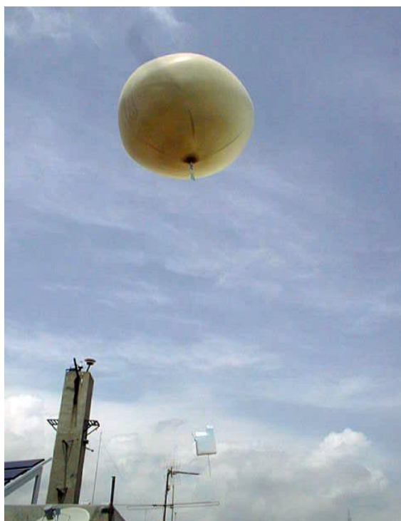
GLOBUS SONDA d'observació aerològica, del SMC, llençat des del terrat de la Facultat de Física, a Barcelona. (Font: M.C. Llasat)
